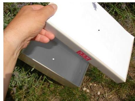
dans sa direction. L'écran est placé à l'arrière et doit être aligné dans l'ombre de la boîte percé du trou. Plus l'ombre est importante plus l'image du Soleil est contrastée. Quand le soleil se couche on voit aussi le paysage de l'horizon sur l'écran. Il est possible d'améliorer le système en plaçant une loupe ou une lentille de verre en lieu et place du trou. L'image de l'éclipse sera ainsi amplifiée.
