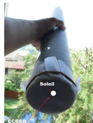
A une extrémité fixer un papier calque transparent et à l'autre extrémité un bouchon percé d'un petit trou.
