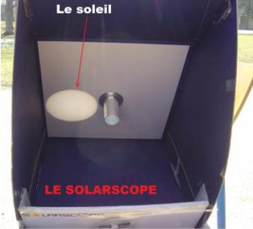
Le Solarscope\* est un outil d'observation solaire pratique et bon marché qui fonctionne sur le principe de la projection. Une loupe sert d'objectif et donne une image amplifiée du Soleil. En l'utilisant de manière régulière vous pouvez mettre en place un atelier suivi de l'activité solaire mais aussi mesurer sa durée de rotation. Il est parfaitement possible de réaliser des dessins
